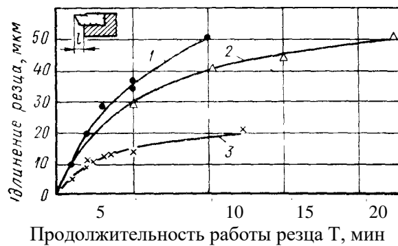
Рис. 6 Кривые температурного удлинения минералокерамического резца: 1 — l = 1,5 мм, 2 — l = 3 мм, 3 — стружка отводилась от резца или задние грани державки изолировались
