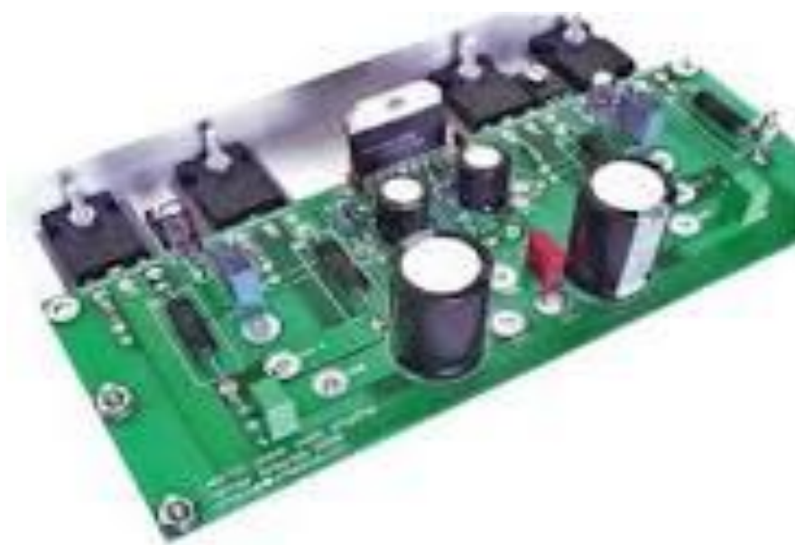
15 – rasm. Ovoz kuchaytirgichning ichki tuzilishi.
